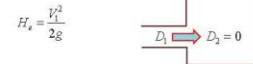
ในกรณีที่ต้องท่อเข้าอย่างทันทีทันใด D_1/D_2 = 0
